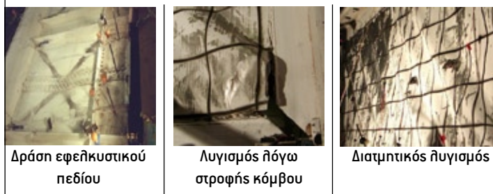
Σχ. 3 Ανελαστικός μηχανισμός απόκρισης μεταλλικών διατμητικών τοιχωμάτων
